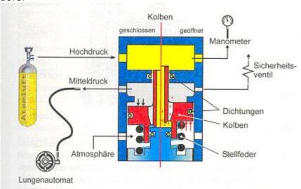
Der Druckminderer reduziert die 200 oder 300 bar auf einen, für den Lungenautomat tauglichen Druck. Im Ruhezustand wird der Kolben gegen die Stellfeder vom Mitteldruck nach unten gedrückt und dichtet so gegen den Hochdruck aus der Atemluftflasche ab.
