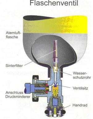
Die Druckluftflasche darf nur mit trockener, öl- und staubfreier Luft befüllt werden. Es werden entweder 4-Liter-Flaschen mit 200 bar oder 6-Liter-Flaschen mit 300 bar verwendet. Natürlich dürfen nur die jeweiligen Flaschen nur mit dem entsprechenden Preßluftatmer benutzt werden.
