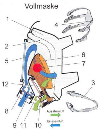
Die Vollmaske ist der Adapter vom Atemschutzgerät (Maschine) zum Gesicht des Trägers (Mensch).
