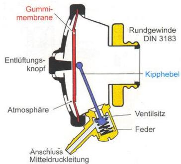
Im Lungenautomaten wird der Kipphebel von einer Feder in seinen Ventilsitz gedrückt. Atmet der Geräteträger ein, entsteht ein Unterdruck, so dass die Gummimembran vom Luftdruck nach innen gegen den Kipphebel gedrückt wird. Dabei wird dieser von seinem Dichtsitz abgehoben und Atemluft aus der Mitteldruckleitung strömt ein. Atmet der Geräteträger aus kommt es zum Druckausgleich, die Membran kehrt in ihre Ausgangsstellung zurück und der Kipphebel verschließt das Ventil wieder.
