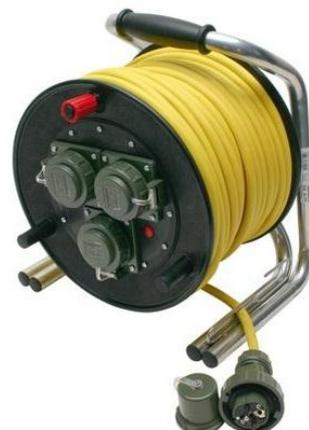
Auf jeder Kabeltrommel der Feuerwehr sind 50 Meter Kabel mit einem Aderquerschnitt von 2,5mm<sup>2</sup> aufgewickelt, während die Länge auf den normalen Kabeltrommeln oft kürzer und der Querschnitt meist nicht mal 1,5mm<sup>2</sup> ist. Stecker und Kupplung haben Schutzkappen, die den Steckkontakt verriegeln und gegen Spritzwasser abdichten.
